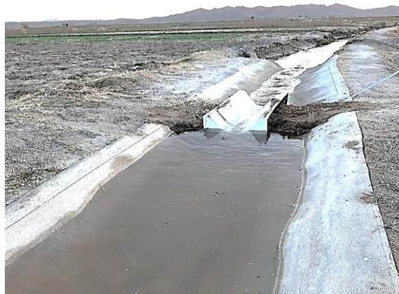
شکل ۶- اندازه‌گیری میزان نشت در کانال با استفاده از فلوم تیپ ۳
