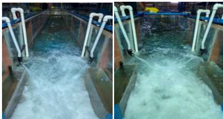
شکل b-۷- اندازه‌گیری سرعت جریان با حضور جت روشن در کانال
