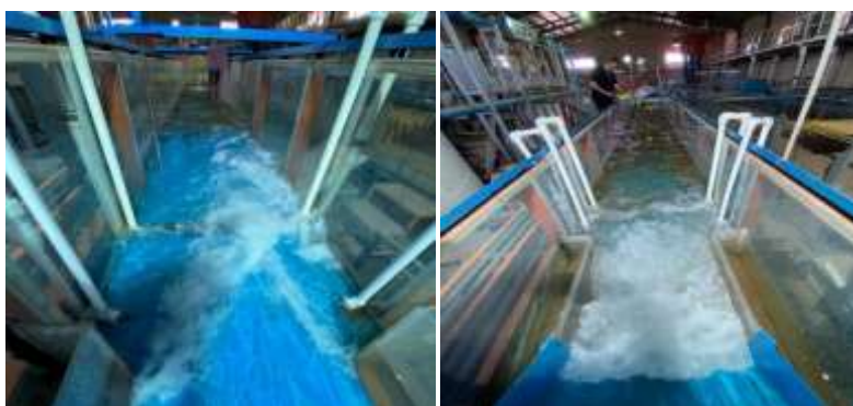
شکل a-۷- اندازه‌گیری سرعت با حضور جت خاموش در کانال
