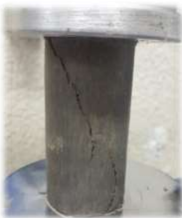
شکل ۴- نحوه شکستن نمونه‌های مقاومت فشاری محدودنشده
