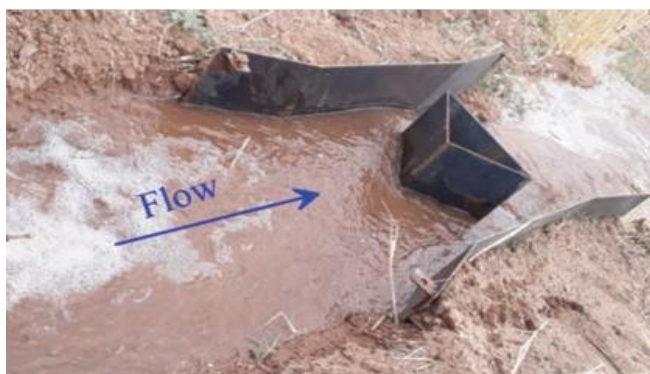
شکل ۶- نمایی از فلوم بافل مرکزی مثلثی (Bijankhan et al, 2022).
