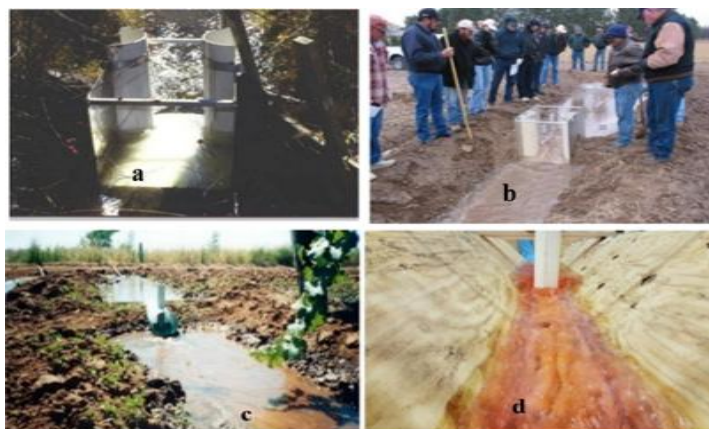
شکل ۵- تصاویری از فلوم‌های استوانه‌ای مورد استفاده در کانال‌های دایره‌ای و دوزنقه‌ای در شرایط (a,b,c) میدانی و (d) آزمایشگاهی اصلاح شده از (Samani, 2017).
