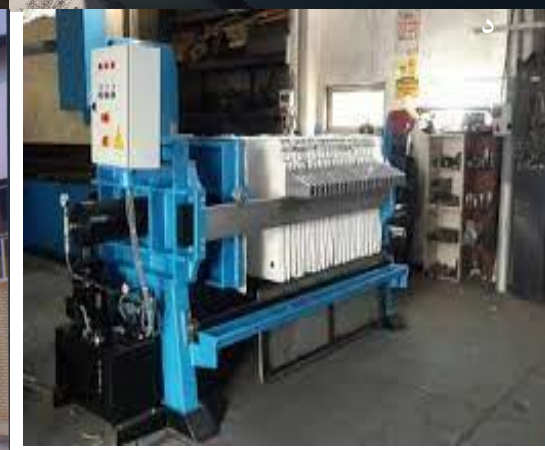
شکل ۲- انواع سیستم تصفیه پساب در کارخانه‌های سنگبری (الف: حوضچه‌های ترسیب سنتی، ب: بشکه دارای همزن برای افزودن اکریلامید به کانال پساب ورودی به حوضچه ترسیب سنتی، ج: مخزن دوکی شکل در کنار محل بارگیری پسماند آبیگری شده فیلتر پرس، د: دستگاه فیلتر پرس خودکار)
