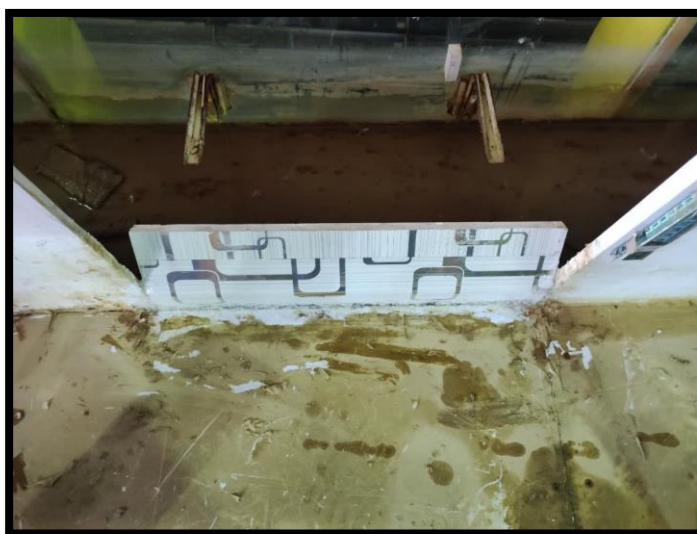
شکل ۲- نمایی از یک مدل نصب‌شده در فلوم تحت زاویه بازشدگی رو به کانال جانبی
