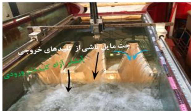
شکل 6- تصویری از جریان عبوری از روی سرریز کلیدپیانویی
