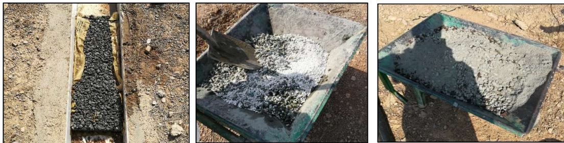
شکل ۷- آماده‌سازی ساخت بتن با پوکهی معدنی شکل ۸- آماده‌سازی ساخت بتن با پرلیت شکل ۹- فراوری بتن متخلخل
