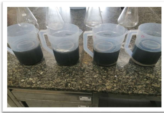
شکل ۱- نمونه‌های آماده شده رسوب در غلظت‌های مختلف محلول
