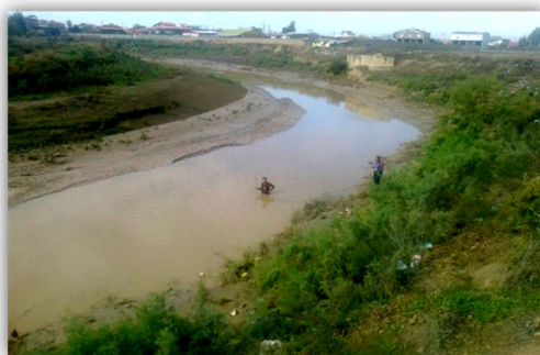
شکل ۳- نمایی از اندازه‌گیری سرعت جریان در محل اولین مقطع از قوس مورد مطالعه
